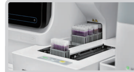
Transfert automatique des frottis préparés sur l'étaleur colorateur SC-120
